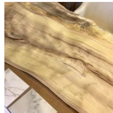
突板（木材を薄くスライスした板材）に加工すると、美しい木目が出てきます。キッチンに使用する突板は、含水率が高いうちに加工されています。乾燥して硬くなると薄くスライスできないためです。
