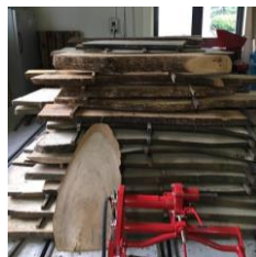
製材された厚板（含水率が高い）を半年ほど自然乾燥させているところです。
